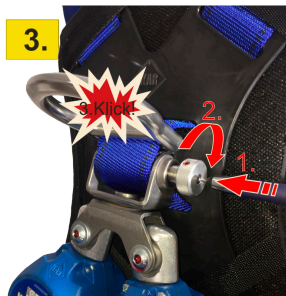
3. Kugelverriegelungsstift eindrücken und Bolzen rechts herum fest drehen. Die Kugeln rasten mit einem KLICK ein
