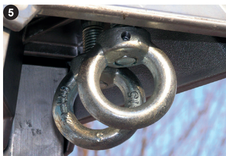
2 forankringspunktene
